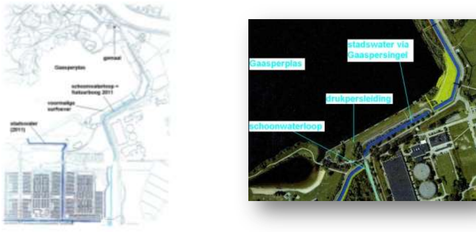
Figuur 4 door de aanleg van de Gaaspersingel sluit de schoonwaterloop via een persleiding aan op de Gaasperplas
